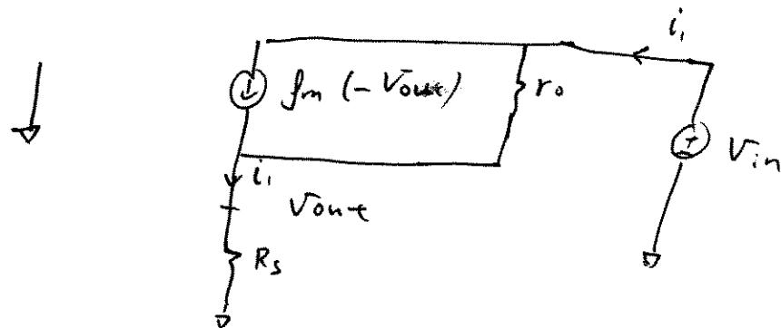
$$i_i = \frac{V_{out}}{R_s} \quad \text{--- (1)}$$
